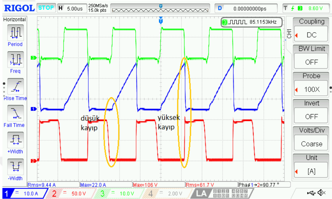
Şekil 0.2. İzoleli cuk çeviriciye ait görev döngüsü sinyali (Kanal: 3 Yeşil), MOSFET akım ifadesi (Kanal: 1 Mavi) ve MOSFET d-s gerilimi (Kanal: 2 Kırmızı) osiloskop ölçümleri
